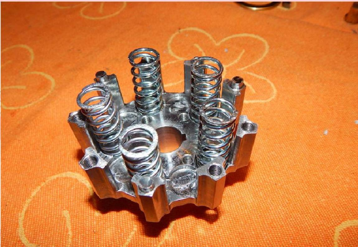
Anschließend wird die obere Federplatte auf den Federteller gesetzt. Dabei ist darauf zu achten, dass die Aussparungen für die Federn miteinander fluchten.
