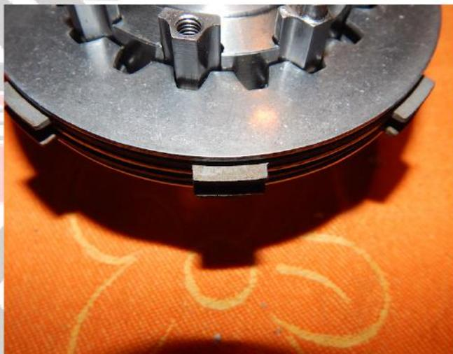
Wenn der 4. doppelseitige Belag verbaut wurde, wird die Deckscheibe zur Fixierung verbaut. Die Schrauben werden mit 15 NM und Schraubensicherung ( mittelfest ) festgezogen. Es empfiehlt sich, den Innenkorb vorab in den Aussenkorb zu setzen, sofern die Kupplungsfaschen nicht ganz fluchten justieren sich diese beim einsetzen.
