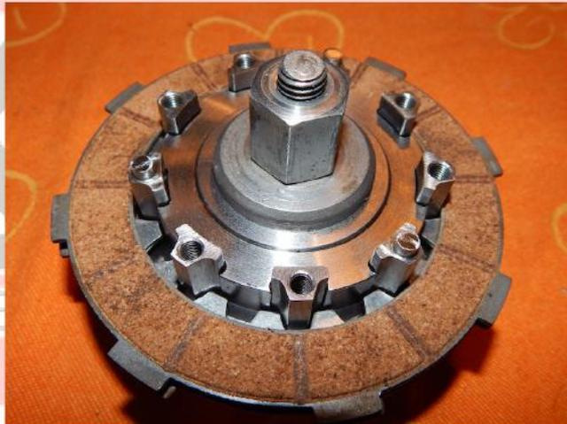
Sofern die Kupplung außerhalb des Korbes zusammengebaut wird, müssen die Kupplungslaschen fluchten, da sich der Belagsatz sonst nicht in den Korb einsetzen lässt.
