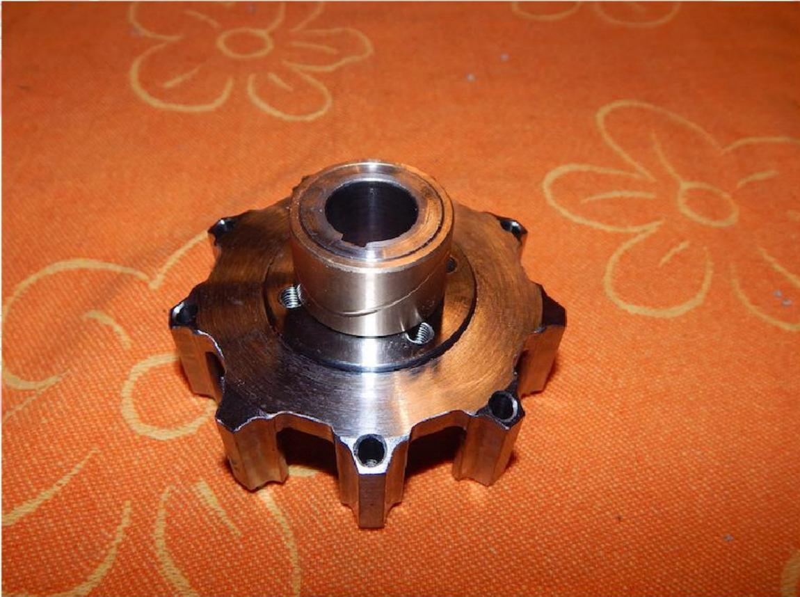
Anschließend wird der Federteller mit Federn ausgestattet, 5 Federn der Stärke XL sollten bis 30 PS reichen. Bei dieser Federbestückung lässt sich die Kupplung noch sehr einfach betätigen.
