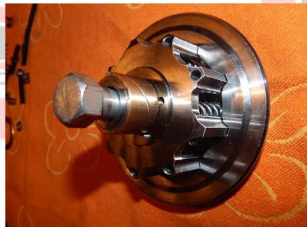
Die Bestückung mit Belägen und Reibscheiben ( Öl nur beispielhaft, es funktioniert jedes SEA 30 ÖL)
